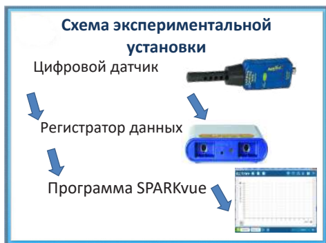
Рисунок 1. Схема экспериментальной установки ЦЛ PASCO
