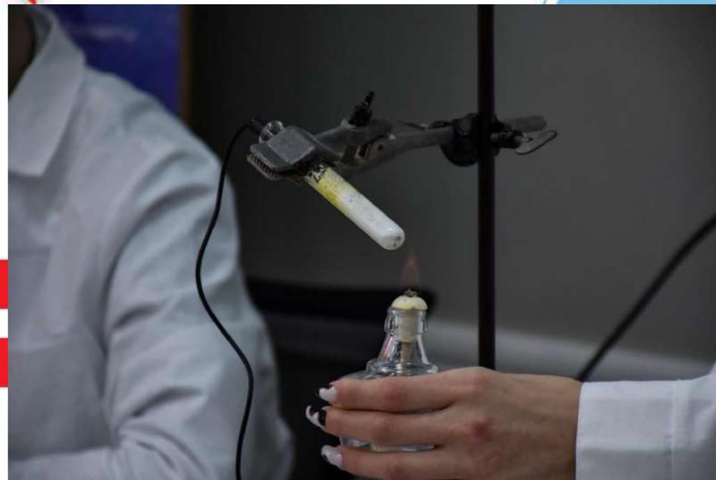
Температурный цифровой датчик позволяет проводить даже самые «капризные» реакции, протекающие в узком интервале температур
